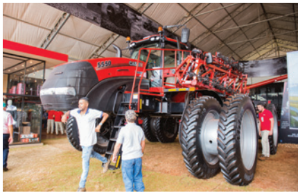
Samojízdný postřikovač Case na pneumatikách Mitas VF 380/105R50 HC 1000.
